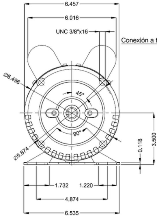
Conexión a tierra 0.5-6 mm<sup>2</sup> / 20-10 AWG
